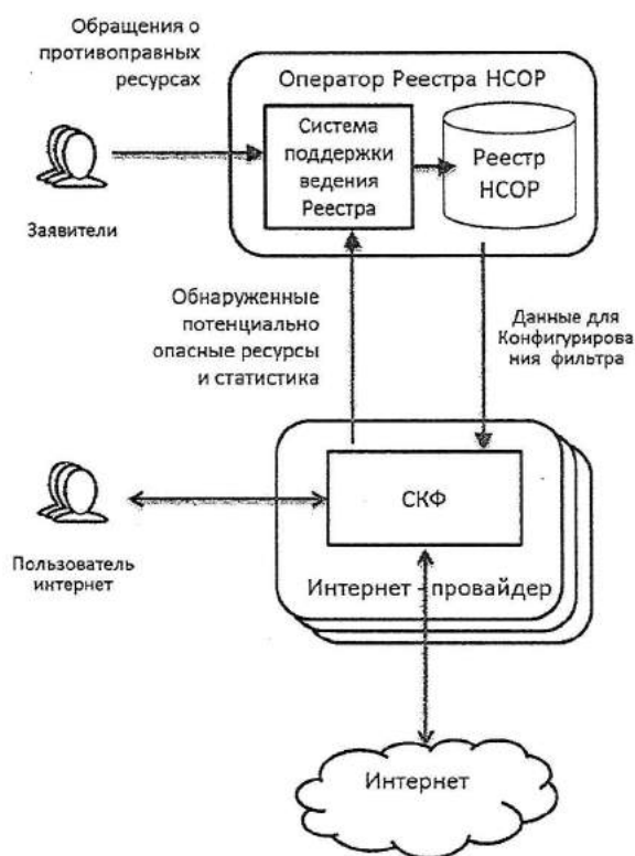
Рисунок 6. Принцип контроля доступа через Реестр NSOP
